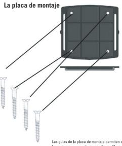
Las guías de la placa de montaje permiten que las guías correspondientes de PowerBlaster™ se deslicen y "enclaven" en su sitio para la instalación en la pared. PowerBlaster<sup>™</sup>
